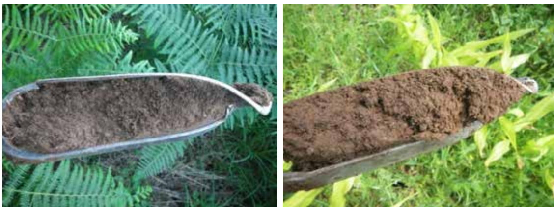
Figure 10 : exemples de sondages à la tarière mettant en évidence le brunisol caractéristique du site « Saudraye » (source : Dervenn, 2014)
