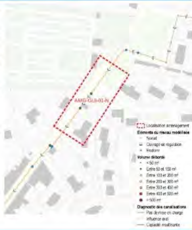
Figure 3 : Localisation des dysfonctionnements au niveau de la rue Marc Mouëllo à Guidel
